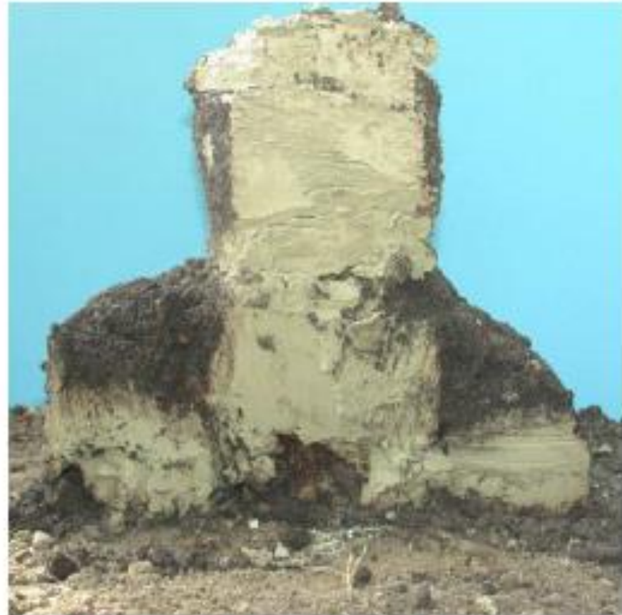
Abb. 143: Füllung eines Pflanzgefäßes der Kontrollversuche. Die Füllung wurde längs halbiert. Die Bereiche mit Bentonit sind frei von Wurzeln.
