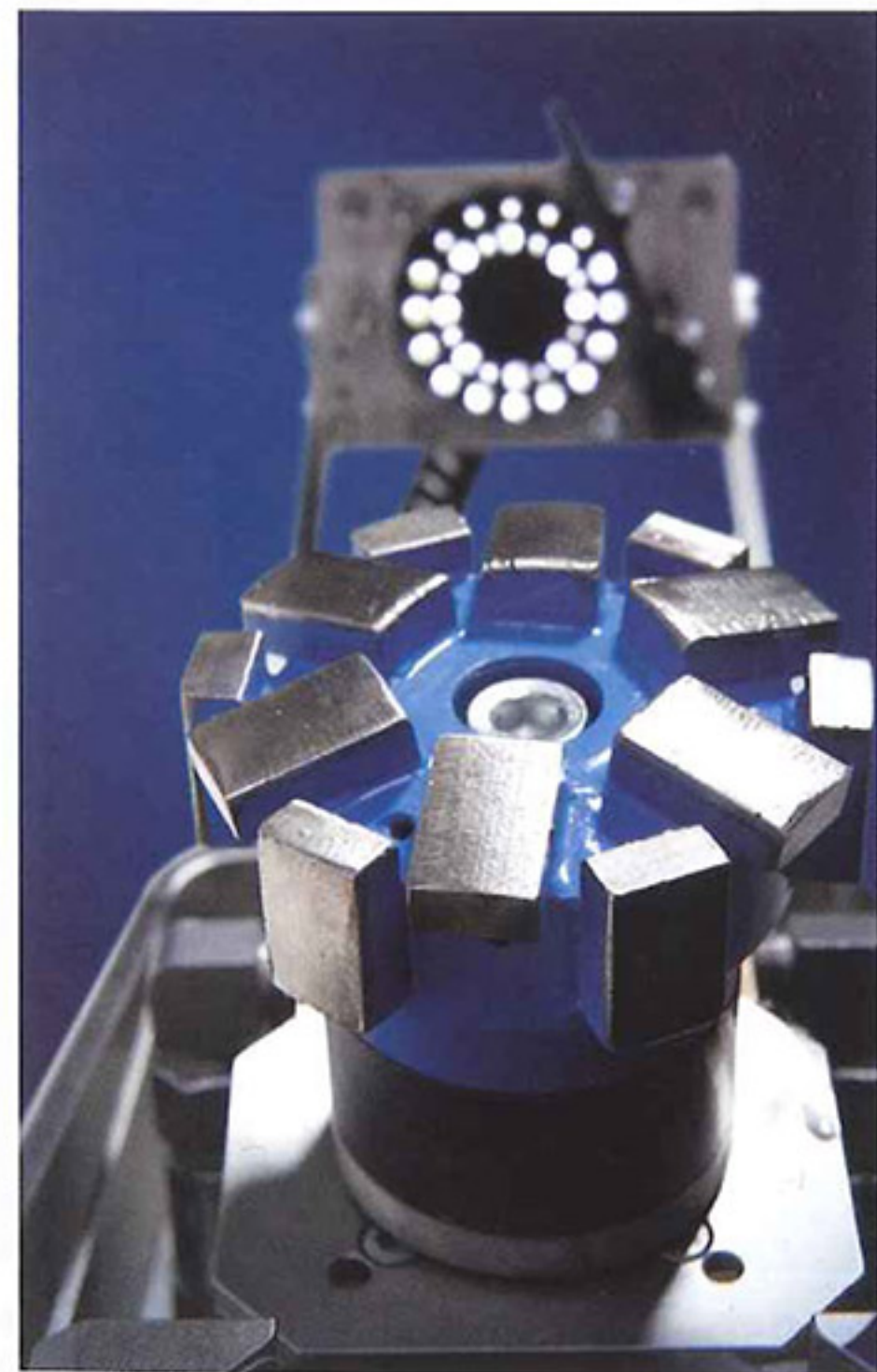
Fräsroboter werden für präzise Fräs-, Bohr- und Schleifarbeiten in Rohrleitungen bis DN 800 eingesetzt. | Foto: KATE PMO AG
