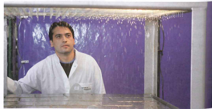
STARKREGENEREIGNISSE: Versickerungsfähige Flächenbeläge im IKT-Test
